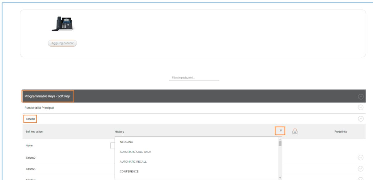
Aprire il menu “Programmable Keys – Soft Keys” per configurare i 4 tasti posti sotto il display
